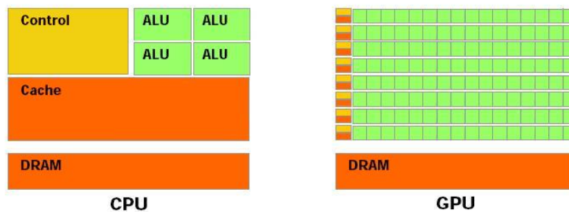
Figura 3.4: Architettura di una CPU e una GPU a confronto
